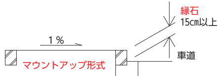
【図4.2】横断歩道部における構造
